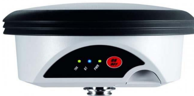
Рисунок 3.1 - Контролер GPS приймача
